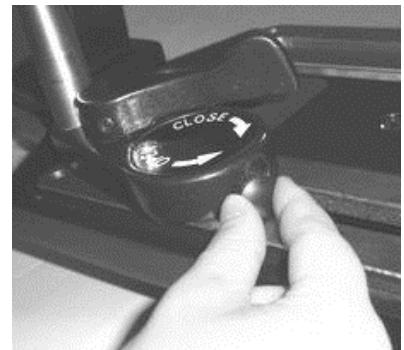
Поверните каретку так, чтобы внешнее отверстие было на одной линии с внутренним. Возьмите шестигранный ключ 3 мм (входит в комплект) и вставьте его во внутренний регулировочный винт.
