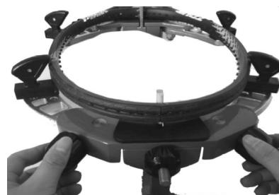
Если во время натяжки струны какой-либо держатель соскочил с обода ракетки, следует остановить натяжку и зафиксировать ракетку повторно.
